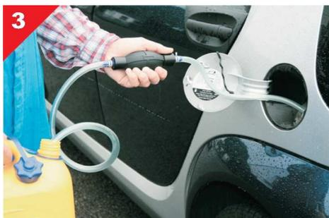
Quando il liquido inizia a defluire, introdurre la seconda estremità del tubo flessibile in un contenitore, per non disperdere il carburante, e continuare a pompare fino allo svuotamento totale del serbatoio.
