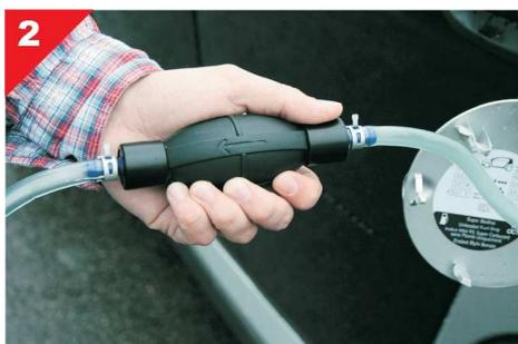
Chiudere l'altro estremo del tubo flessibile con un dito, al fine di creare la pressione necessaria per iniziare il flusso di carburante in uscita dal serbatoio.
