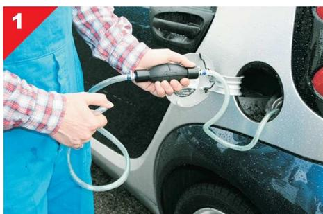
Introdurre nel serbatoio l'estremità del tubo flessibile che si trova sul lato opposto da quello segnalato dalla freccia di direzione di flusso.
